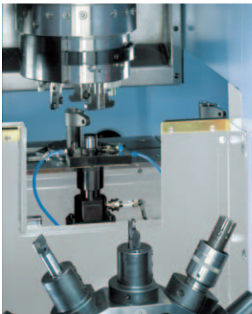
采用测量芯棒测量孔 (测量芯棒和加工区之间的保护门打开)
