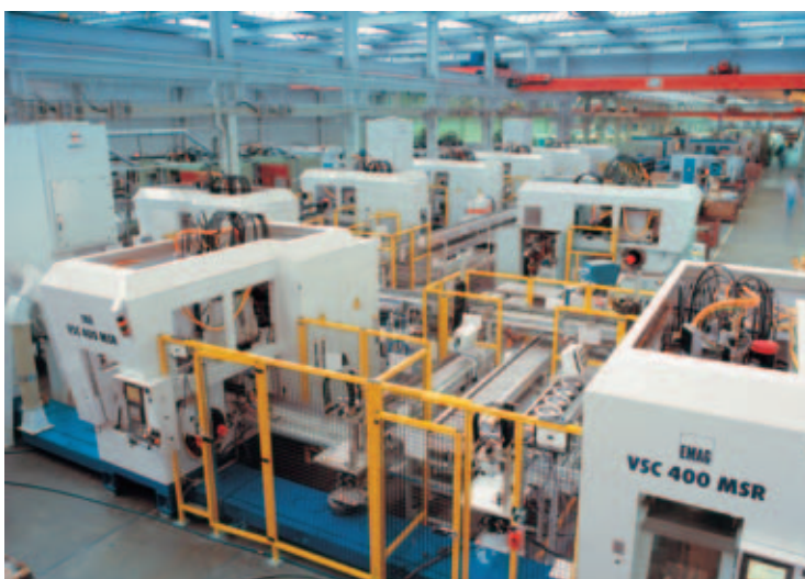
VSC 多功能生产中心经常被巧妙地联机到生产线上使用，为工件的组合加工提供了最佳的生产方案。图中案例是 8 台机床联机对制动盘进行全套组合加工
