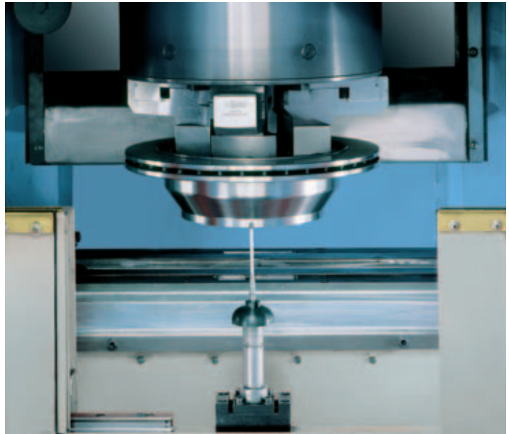
配置的测头正在测量工件。 (测头和加工区之间的保护门打开)
