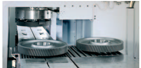
工件从进料道被输送到上下料位置后直接由卡盘夹取
