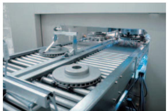
双轨道输送系统，换工件迅速
