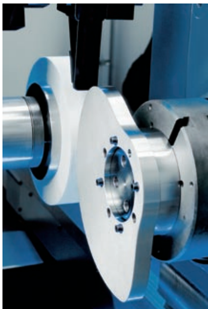
SK 204 凸轮磨床的加工区 正在磨削一个径向凸轮
